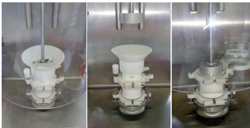
Obr. 25 Snímka prístroja Freeman FT4 počas rôznych fáze merania
