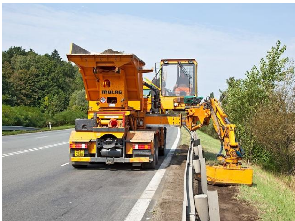
Obr. 2 MULAG HS 2400 při seřezávání krajnice [10]
