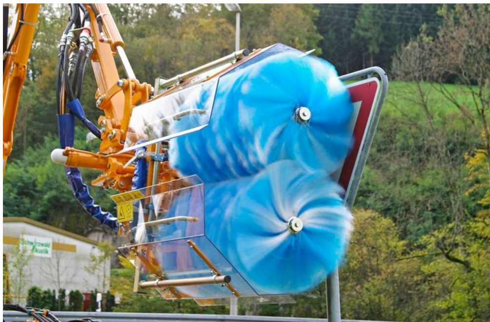
Obr. 4 Čištění dopravní značky [10]
