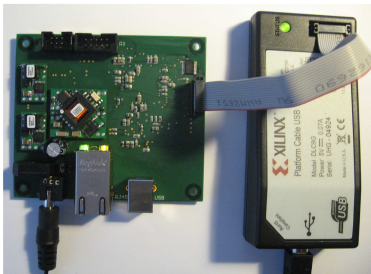
Obr. 8.4: Ověření funkčnosti obvodu FPGA
