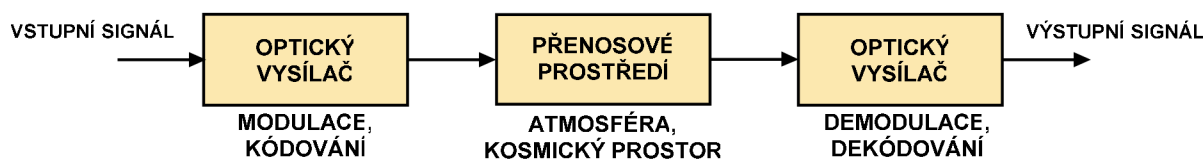
Obr. 2.1: Základní blokové schéma optického komunikačního systému
