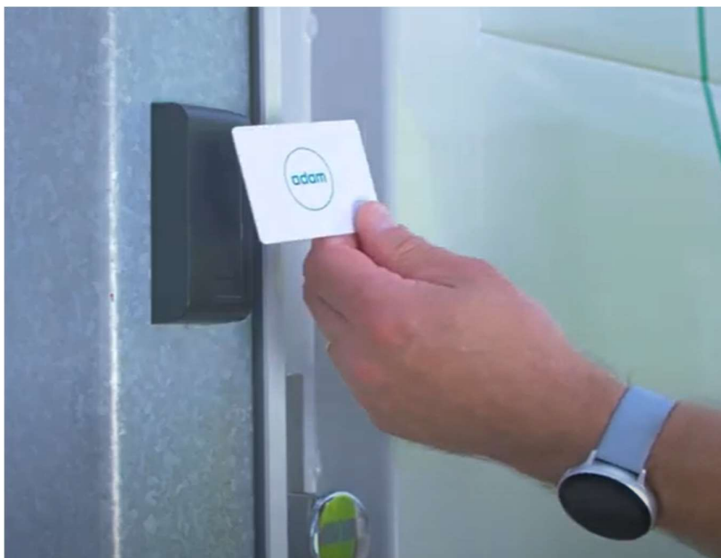
Obrázek 6: RFID čtečka s přístupovou kartou [26]
