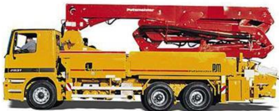
[obr 917. Betonové čerpadlo Putzmeister M31]
