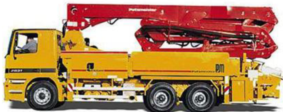
[obr 917. Betonové čerpadlo Putzmeister M31]
