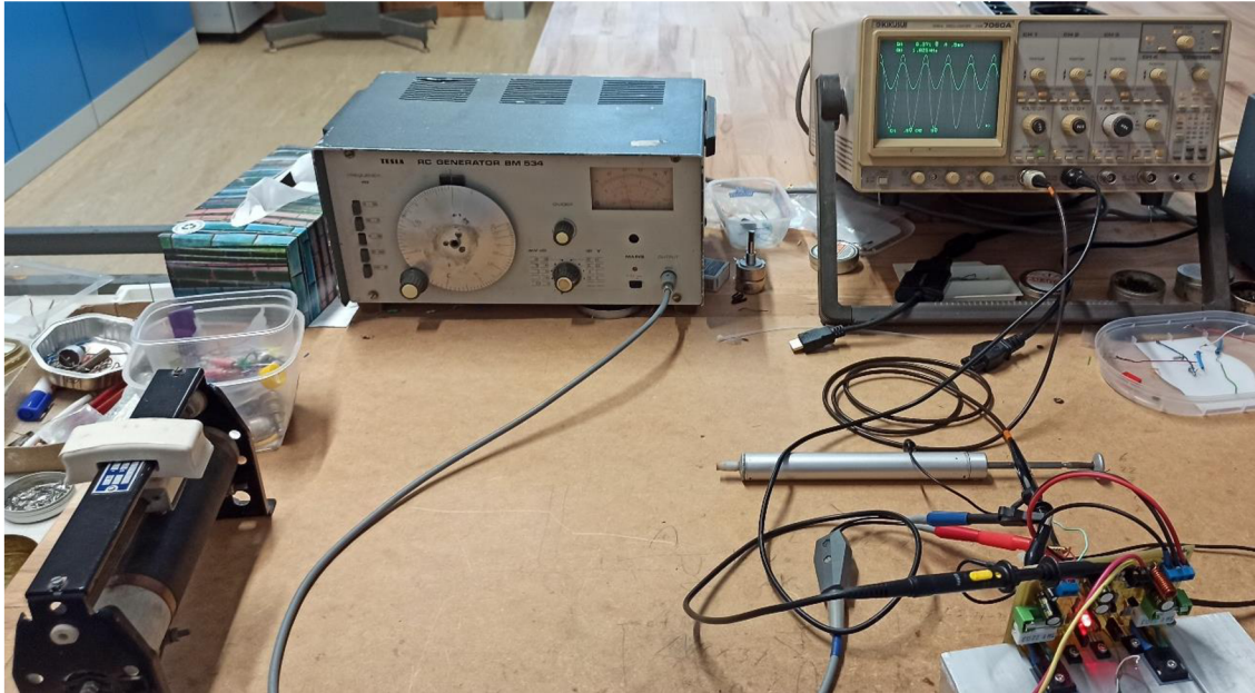
Obrázek 22 Pohľad na meracie pracovisko, na ktorom používame generátor Tesla BM534, osciloskop Kikusui 7060A, 4\ \Omega záťaž, a koncový stupeň audiozosilňovača.
