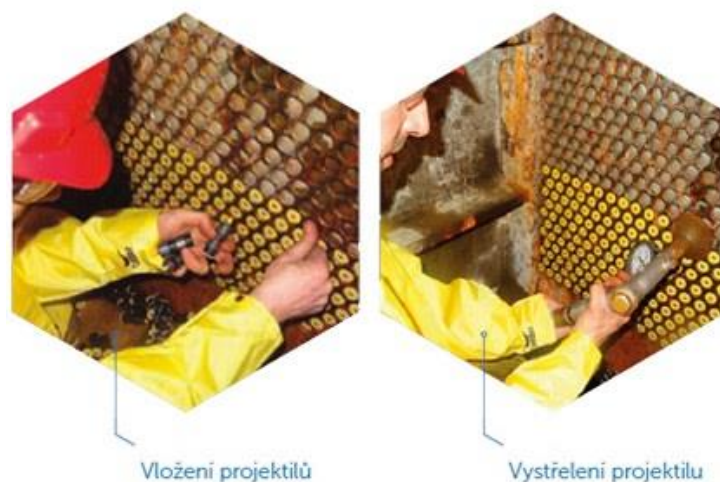
Obr. 33 Nábojové čistenie trubiek [21]
