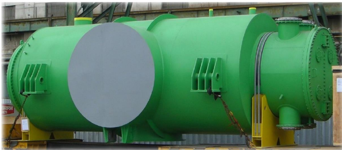
Obr. 22 Plášť valcového povrchového kondenzátora s axiálnym vstupom [11]
