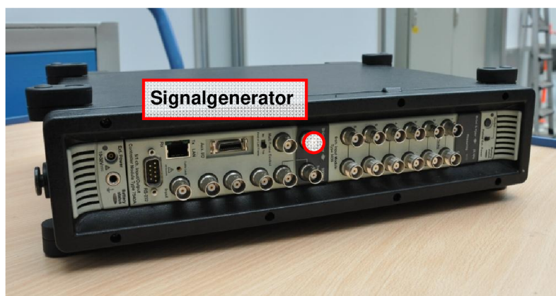
Abbildung 4.1: FFT-Analysator mit dem hervorgehobenen Signalgenerator
