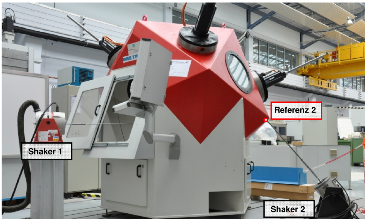
Abbildung 4.2: Anordnung zur Messung einer MIMO-Analyse
