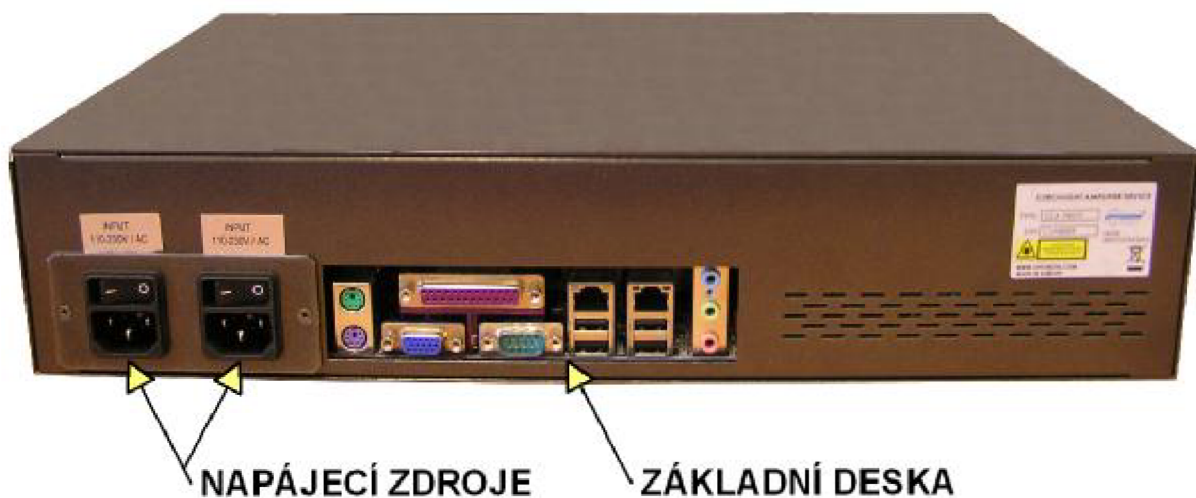
Obr. 6.2: Optický zesilovač EDFA CLA-PB01F – zadní strana
