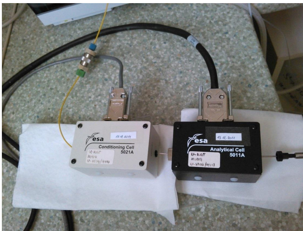
Obr.č. 11: Kondičionální cela a analytická cela v HPLC/ED sestavě
