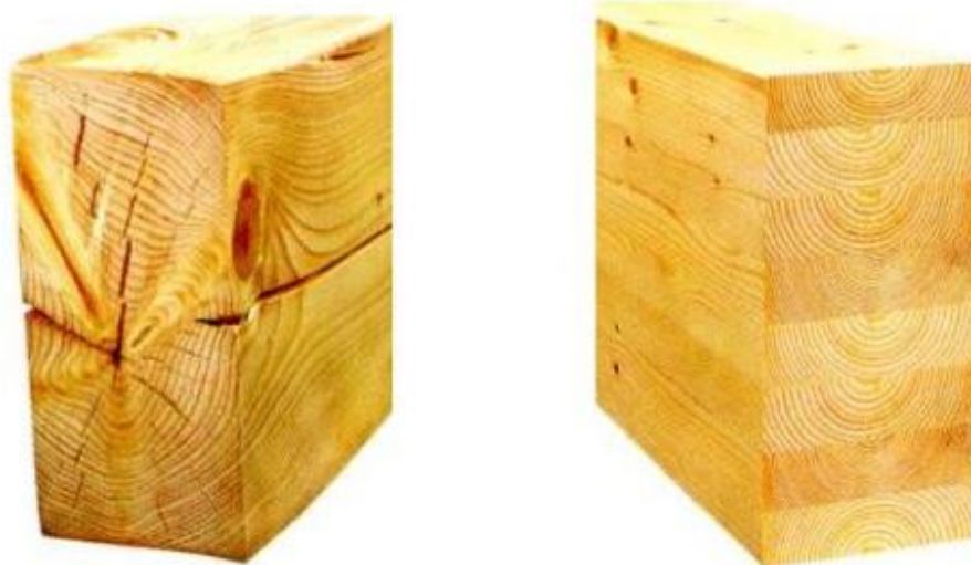
Obr. 21 - Rozdíl mezi rostlým dřevem (vlevo) a BSH hranolem (vpravo), (Blass, 2013)
