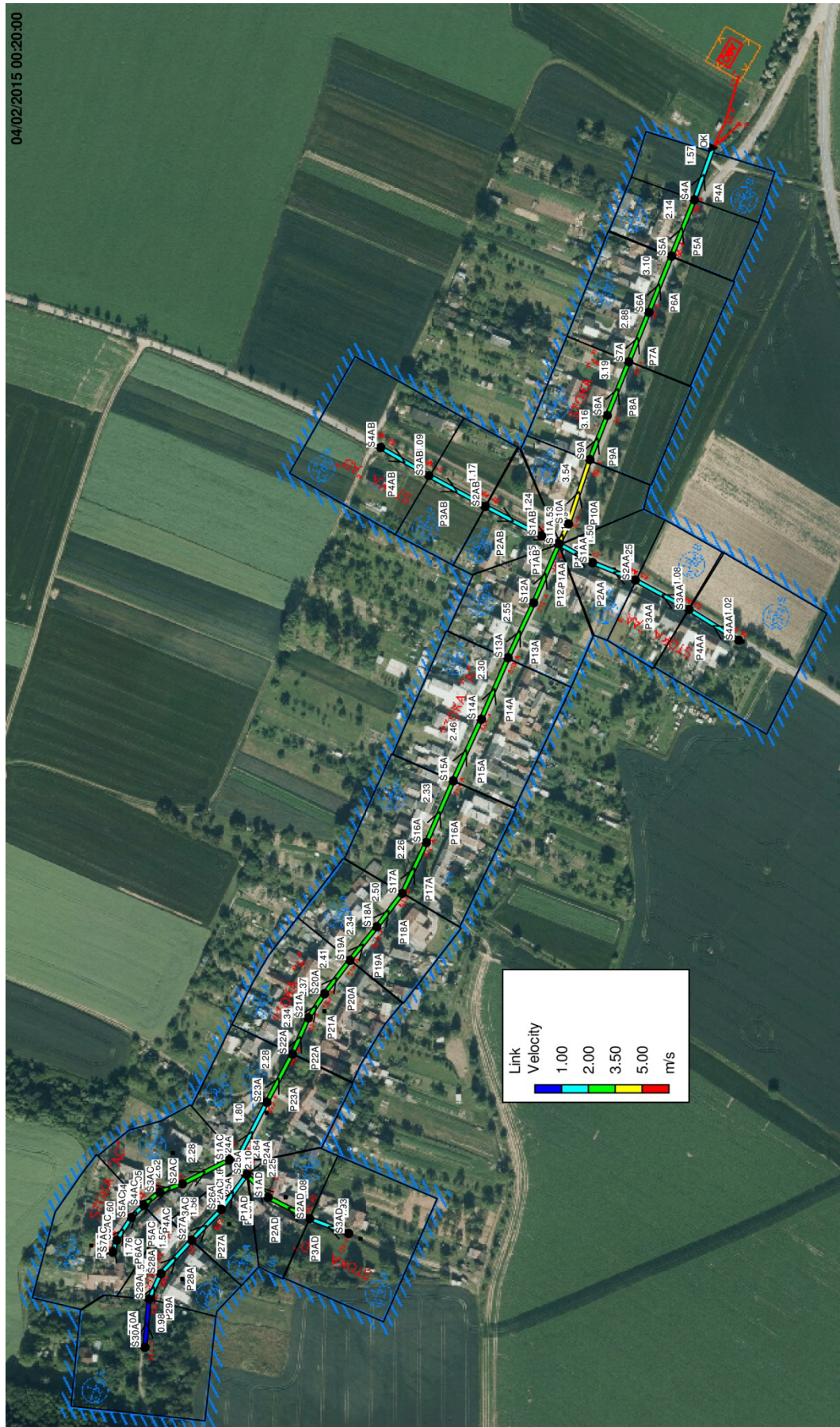
Obr. 4-6 Grafické vyznačení rychlosti proudění v potrubí
