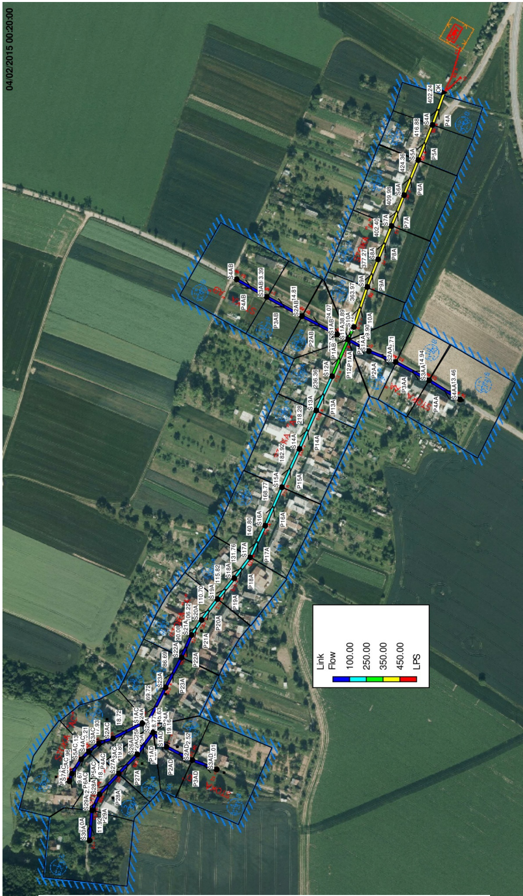
Obr. 4-5 Grafické vyznačení průtoků v potrubí
