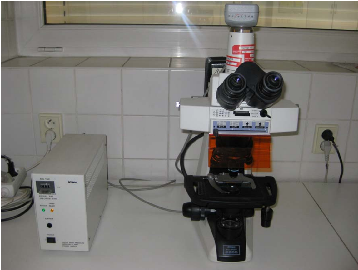
Obr. 24: Mikroskop Nikon Eclipse E 200 s fluorescenčním nástavcem a CCD kamerou Pixel Link PL-A 662
