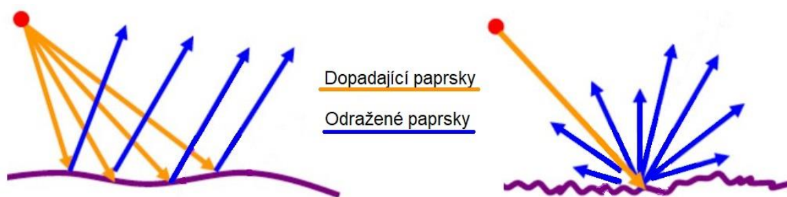
Obr. 4-4 Zrcadlový odraz (vlevo) a difúzní odraz (vpravo) [55]
