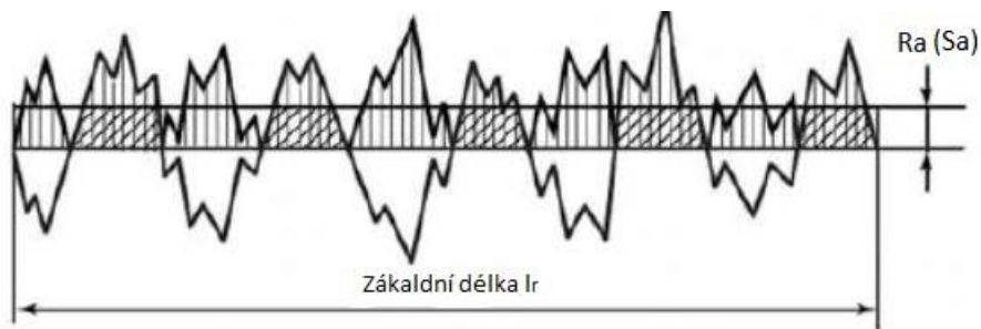
Obr. 3-5 Grafické znázornění parametru Ra (ve 3D Sa) [14]
