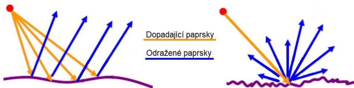
Obr. 4-4 Zrcadlový odraz (vlevo) a difúzní odraz (vpravo) [55]
