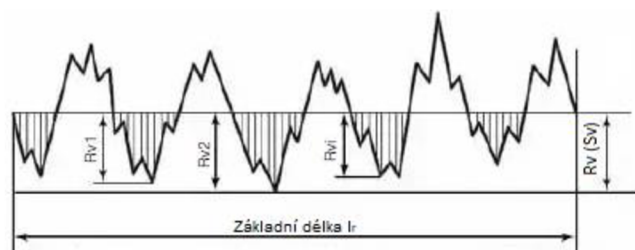
Obr. 3-9 Grafické znázornění parametru R_v (ve 3D S_v ) [14]
