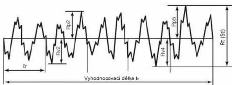
Obr. 3-10 Grafické znázornění parametru R_t (ve 3D S_z ) [14]
