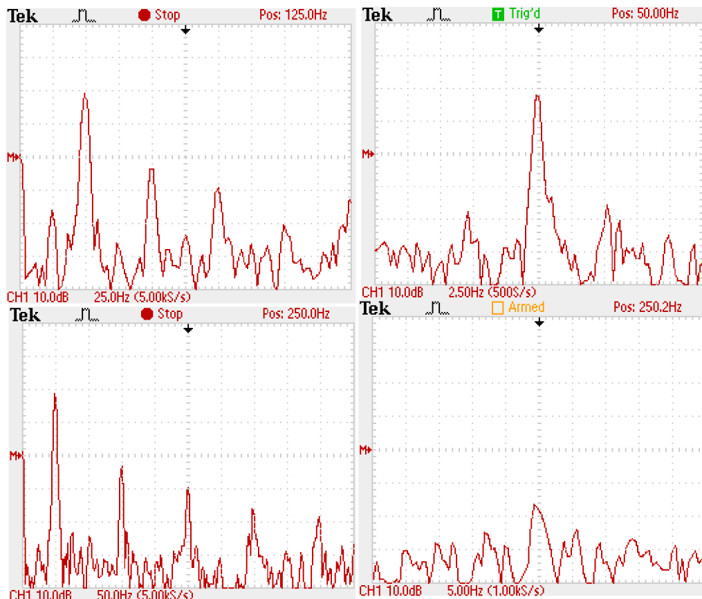
Obr. 41. – Naměřená spektra proudu, II. převodový stupeň (50Hz) se simulovanou nesymetrií: a) okolo první harmonické se objevují stopy zátěže (pásma \pm 25 Hz); b) dále jsou zde patrná postranní pásma \pm 5 Hz, jež by mohla odpovídat vyššímu ozubenému kolu planetové převodovky; c) a d) patrný je i vznik postranních pásem okolo 250 Hz, jež s nejvyšší pravděpodobností odpovídaly zátěži při převodu cca 5.
