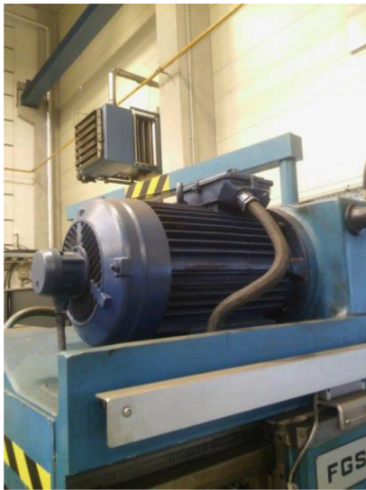
Obr. 25. – Ilustrativní fotografie vřetenového motoru vertikální frézky FGW50.
