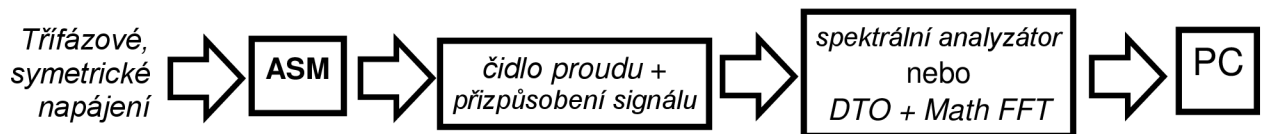
Obr. 2. – Principiální schéma on-line vyhodnocování spektra statorového proudu.
