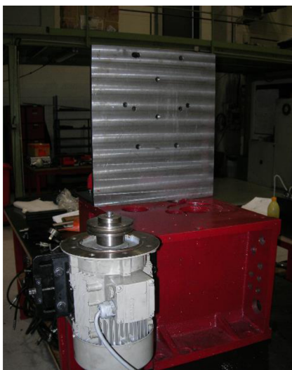
Siemens 3~mot 1LE1002 1AB42 2AA0 400V Y, 50Hz, 4,8A, 2,2kW, 1425 min -1
