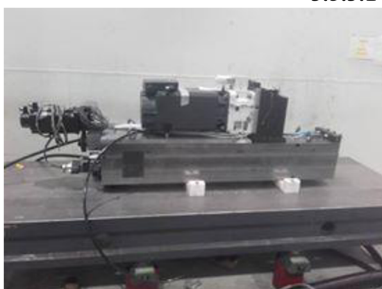
Obr. 42. – a) Ilustrativní fotografie uspořádání vřeteníku ukotveného k litinové plotně pomocí čtyřech šroubů přes distanční silonové držáky; b) ilustrace uspořádání přenosu točivého pohybu vřeteníku.
