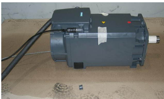
Obr. 29. – Ilustrativní fotografie motoru 1PH8137 s připojeným napájením z měniče kmitočtu, odměřování absolutního úhlu natočení a ventilátoru.
