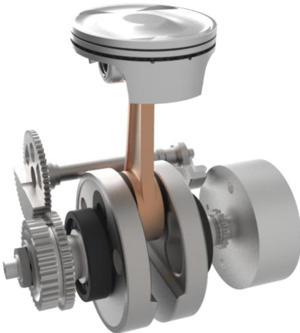
Obr. 1 3D model hnacího ústrojí s protiběžným vyvažovacím hřídelem motoru Husaberg FE 570 [3]
