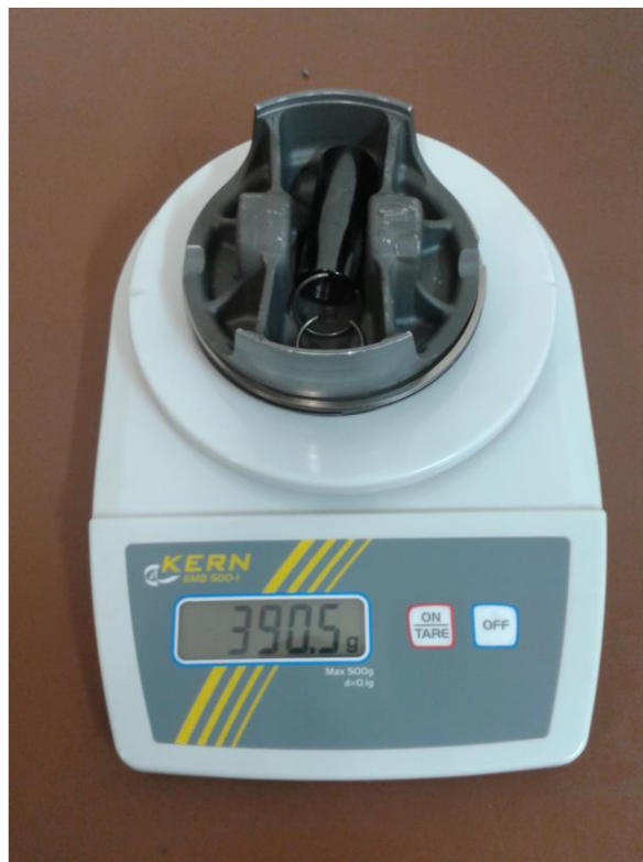
Obr. 6 Vážení pístní skupiny z modelu FE 570
