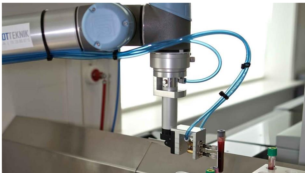
Obr. 5: Kolaborativní robot při manipulaci se vzorkem krve [10]
