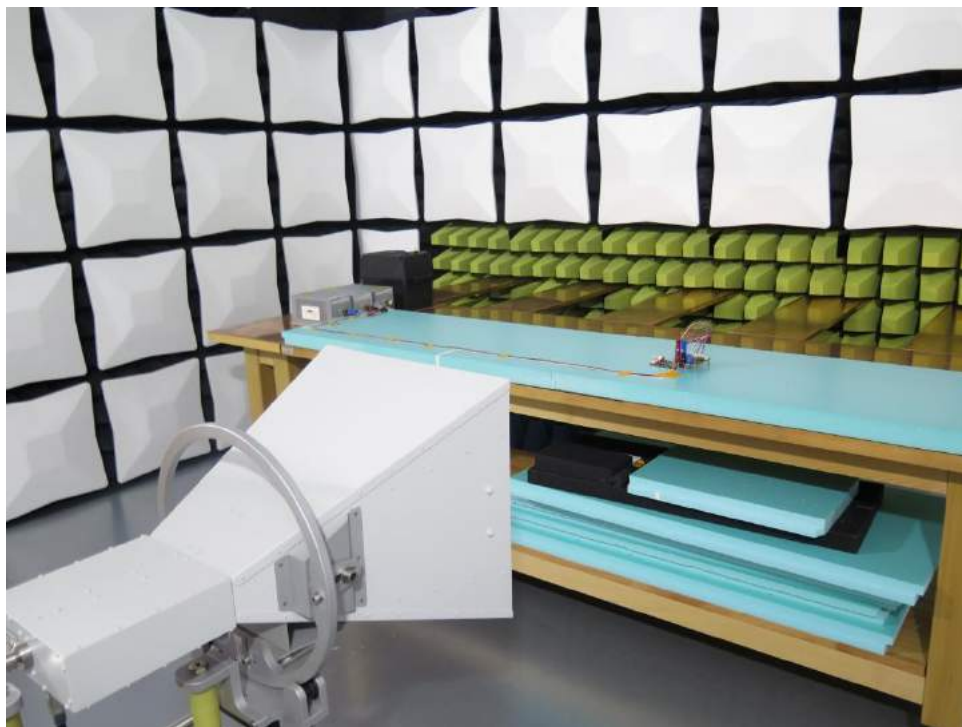
Obr.42: Uspořádání pracoviště při měření vyzařovaných emisí (1GHz - 2,6 GHz)
