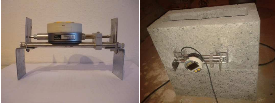
Obrázek 8.6: Kombinace plíšku s ocelovým můstkem (vlevo), osazení měřicí soustavy do tvarovky (vpravo)
