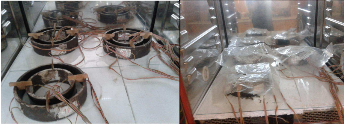
Obrázek 8.4: Měření objemových změn pomocí prstenců
