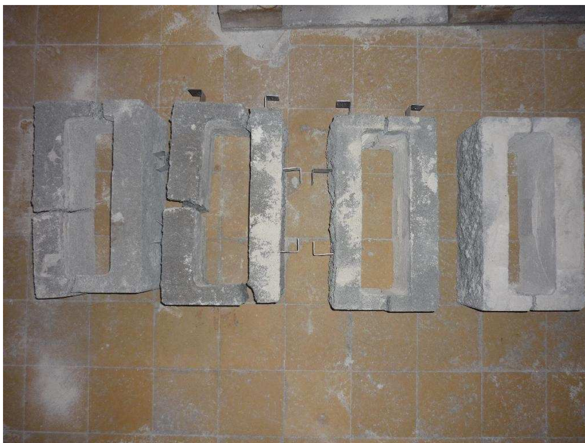
Obrázek 9.2: Deformace tvarovek vlivem expanzní směsi
