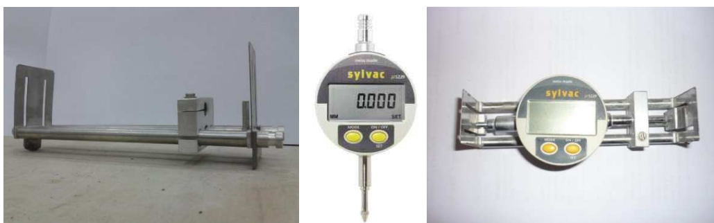
Obrázek 8.5: Kombinace ocelového můstku s digitálním úchylkoměrem
