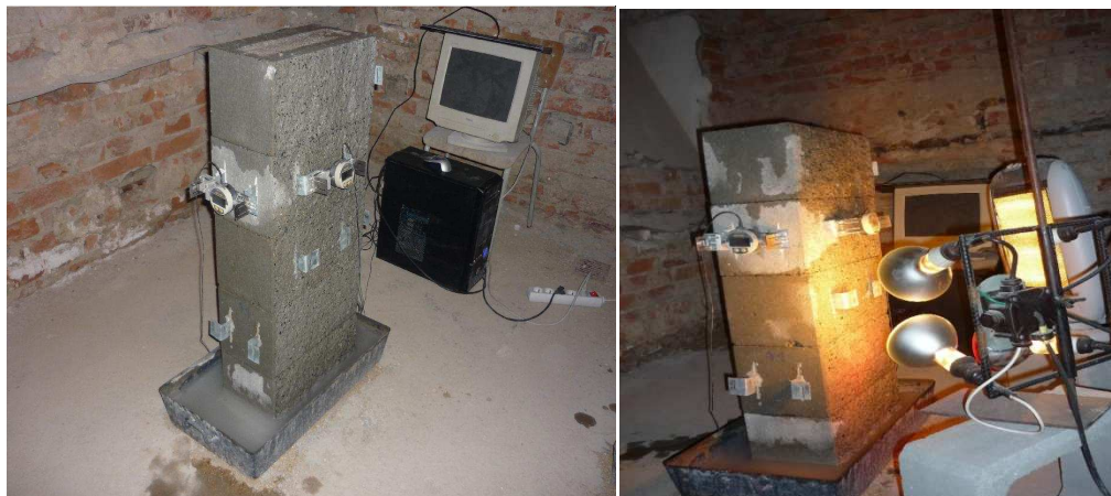
Obrázek 9.11: Osazení sloupků měřicí soustavou
