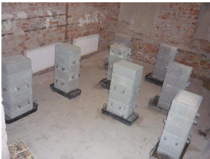
Obrázek 8.3: Sloupky z tvárnic typu Face Block a Simple Block
