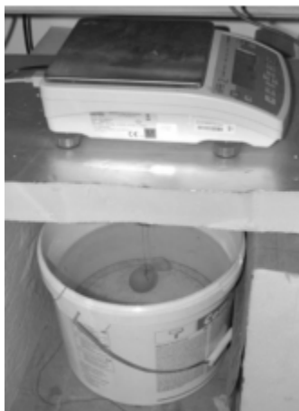
Obrázek 6.1: Měřicí soustava při hydrostatickém vážení, převzato z [19]
