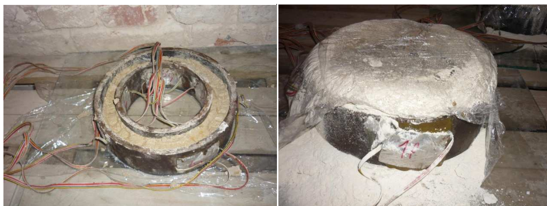
Obrázek 9.3: Měření mezního přetvoření prstencovou metodou
