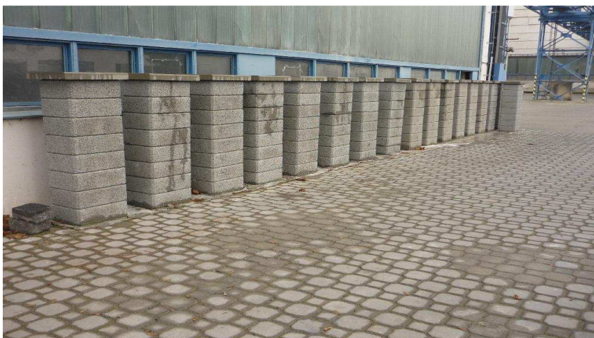
Obrázek 3.7: Výběr z fotodokumentace, experimentální výstavby sloupků – zkušební sloupky realizované výrobcem tvárnic
