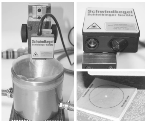
Obrázek 6.3: Měřicí soustava kuželové metody, převzato z [29]
