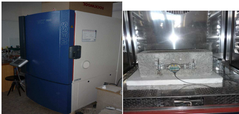
Obrázek 9.5: Měření přetvoření vyplněné tvarovky působením mrazu
