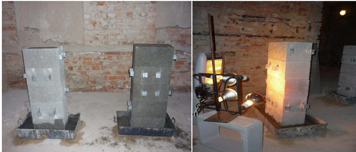
Obrázek 9.8: Vlhčení a vysoušení sloupků
