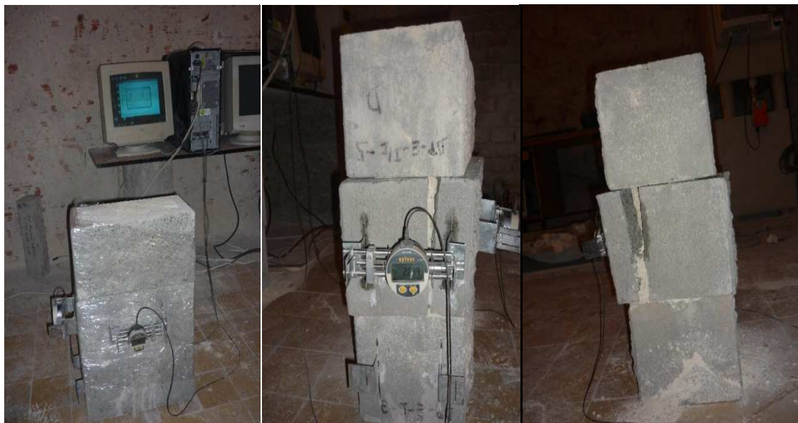
Obrázek 9.1: Měření mezního přetvoření, metodou můstku
