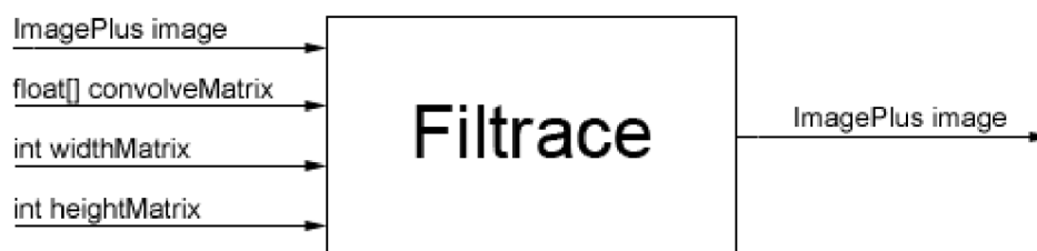
Obrázek 5.2: Principiální schéma komponenty pro návrh konvolučního filtru.
