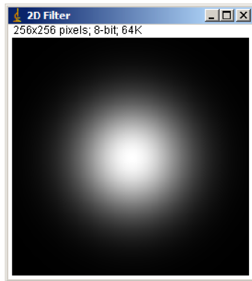
Obrázek 4.4: Implementace plug-inu Gaussova filtru v ImageJ
