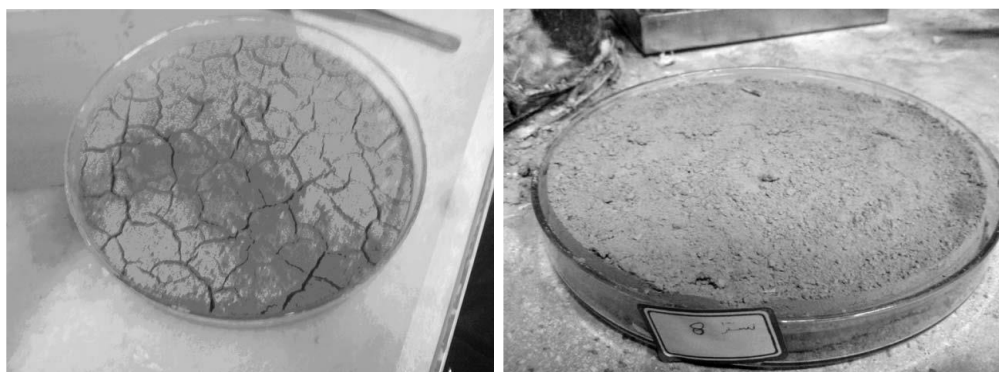
Obrázek 12 srovnání vzorku půdy bez aplikace PAM (vlevo) a vzorku po aplikaci aniontové formy PAM (vpravo), (Rabiee et al. 2013).
