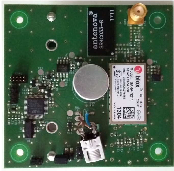
Obr. B.4: Vyrobená a osadená DPS s rádiovým modulom SARA N211 z hornej strany.
