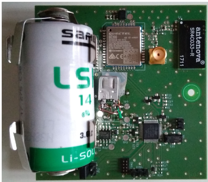
Obr. B.2: Vyrobená a osadená DPS s rádiovým modulom Quectel BC66 z hornej strany.
