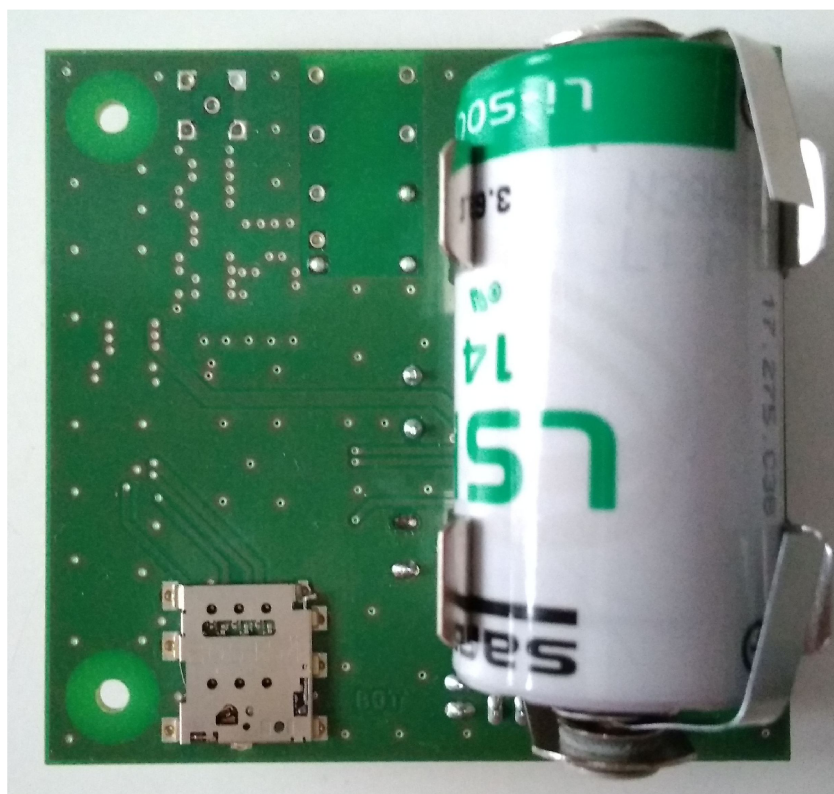
Obr. B.5: Vyrobená a osadená DPS s rádiovým modulom SARA N211 zo spodnej strany.
