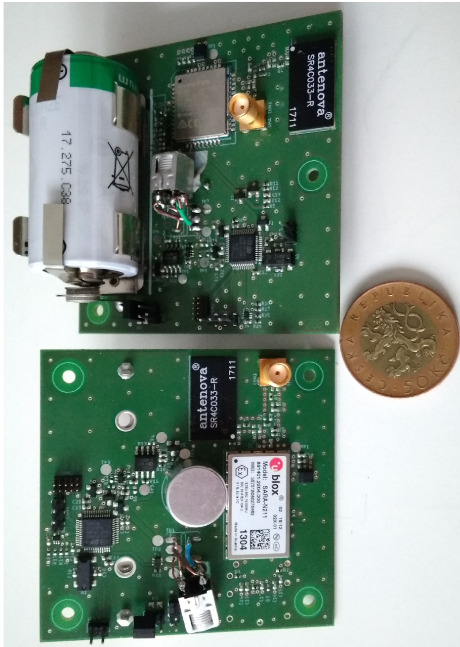
Obr. B.1: Vyrobené a osadené DPS z hornej strany, DPS s rádiovým modulom SARA N211 vľavo, DPS s rádiovým modulom Quectel BC66 vpravo.
