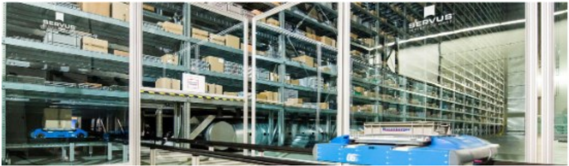
Obr. 2.13 Automatizované skladování a re-trial systém bez rozhraní Zdroj: firemní prezentace společnosti Servus Intralogistics GmbH.
