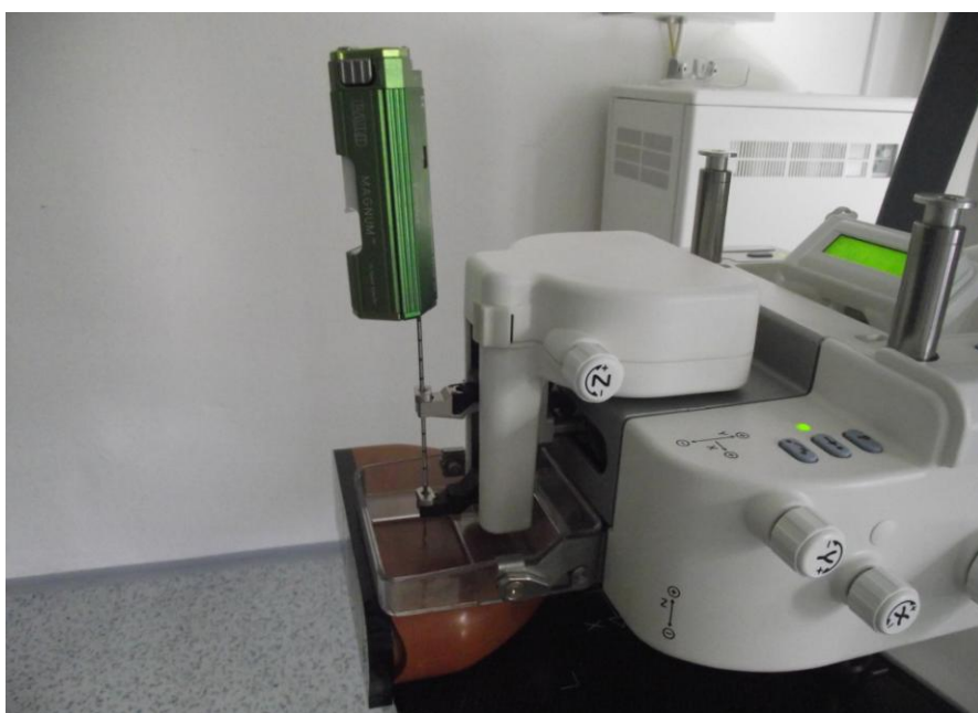
Obrázek č. 10: Stereotaktický polohovač s umělým ňadrem a bioptickým dělem
