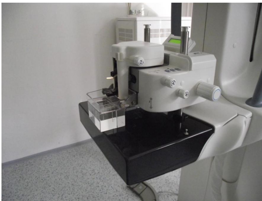
Obrázek č. 9: Mamograf se stereotaktickým polohovačem a fantomem
