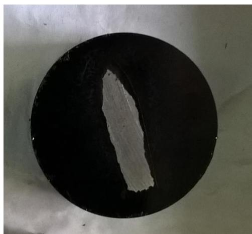
Obrázek 33 Vzorek po vyndání ze zapékacího lisu.
