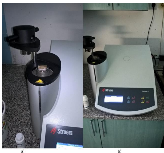
Obrázek 34 Lis na metalografické vzorky Struers (b) a ukázka uložení vzorku před zapékáním (a).
