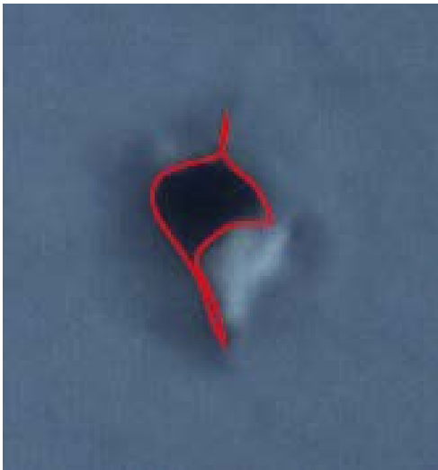
Obr. 56 Tvar vpichu jehly do usně – hrot R
