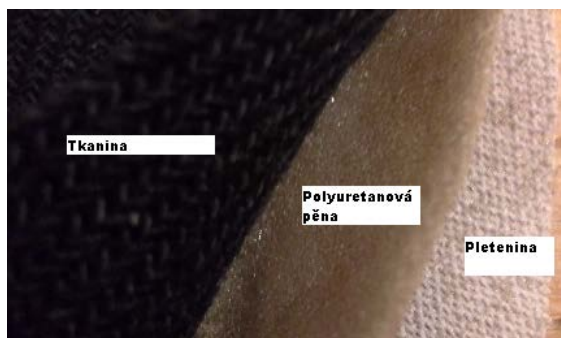
Obr. 3 Složení kompozitního materiálu [vlastní zdroje]
