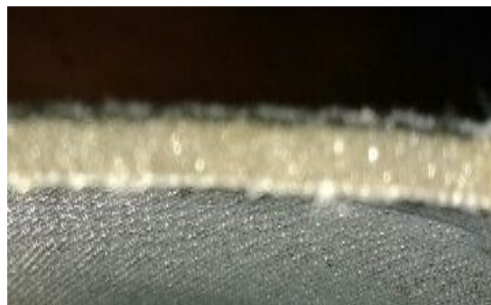
Obr. 4 Průřez kompozitním materiálem [vlastní zdroje]
