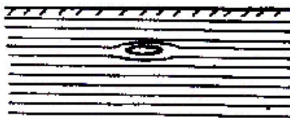
Obrázek 2.8 Vada umístěna souběžně z rozptylovým tokem
