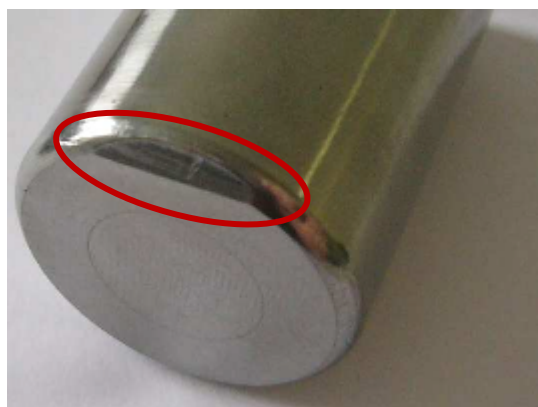
Obrázek 3.6 Zábrus na čele při přechodu do rádiusu
