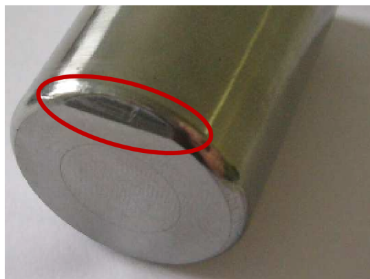
Obrázek 3.6 Zábrus na čele při přechodu do rádiusu
