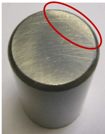
Obrázek 3.5 Zábrus na čele
