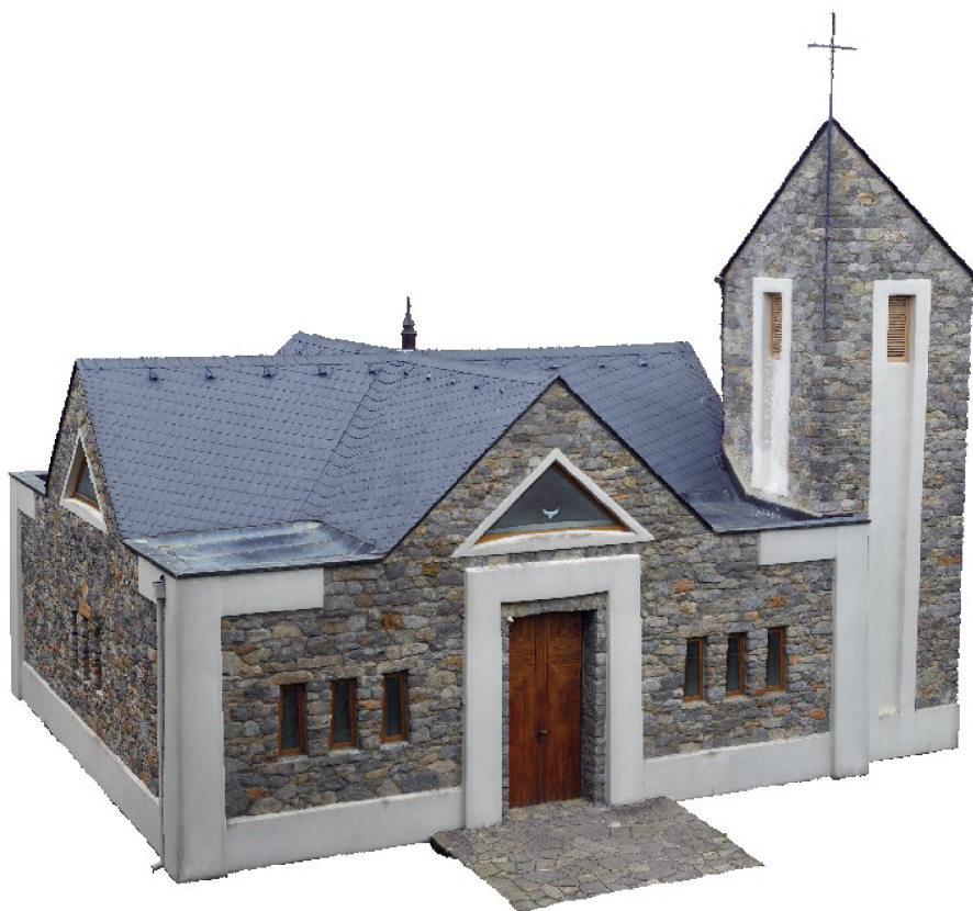
Obr. 26 Texturovaný 3D model ze snímků z kamery Canon.
