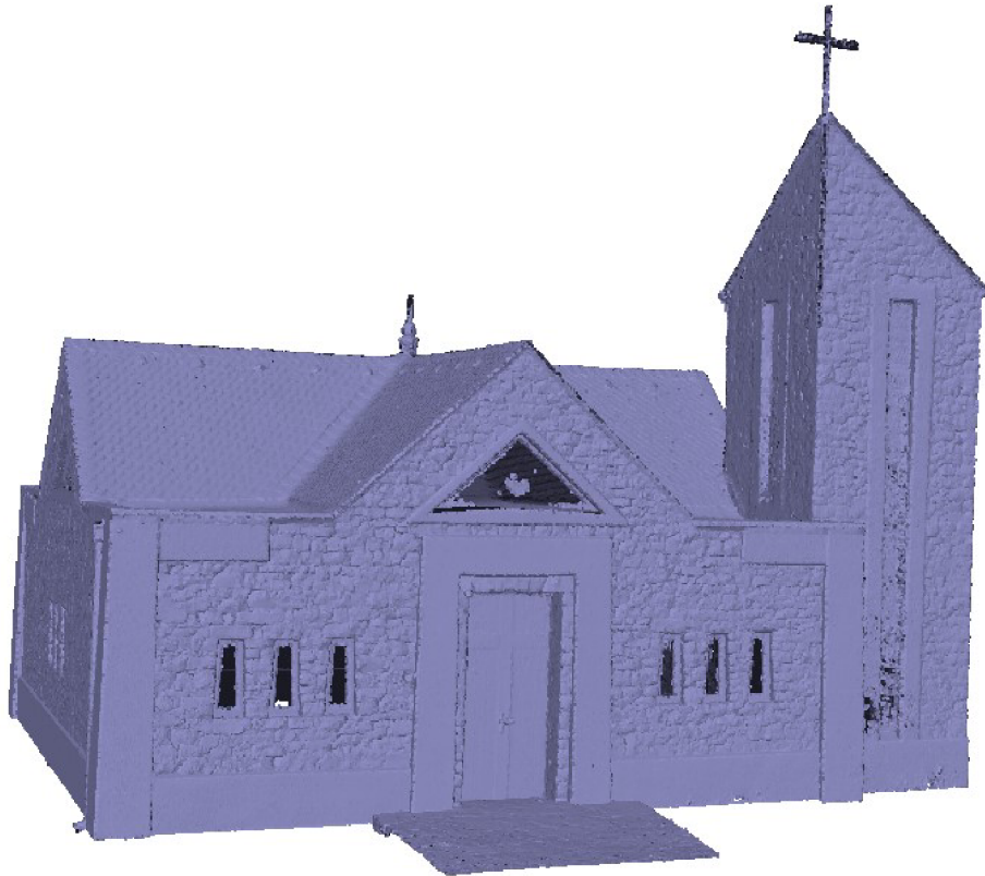
Obr. 14 Spojená mračna bodů Canon + Phantom.
