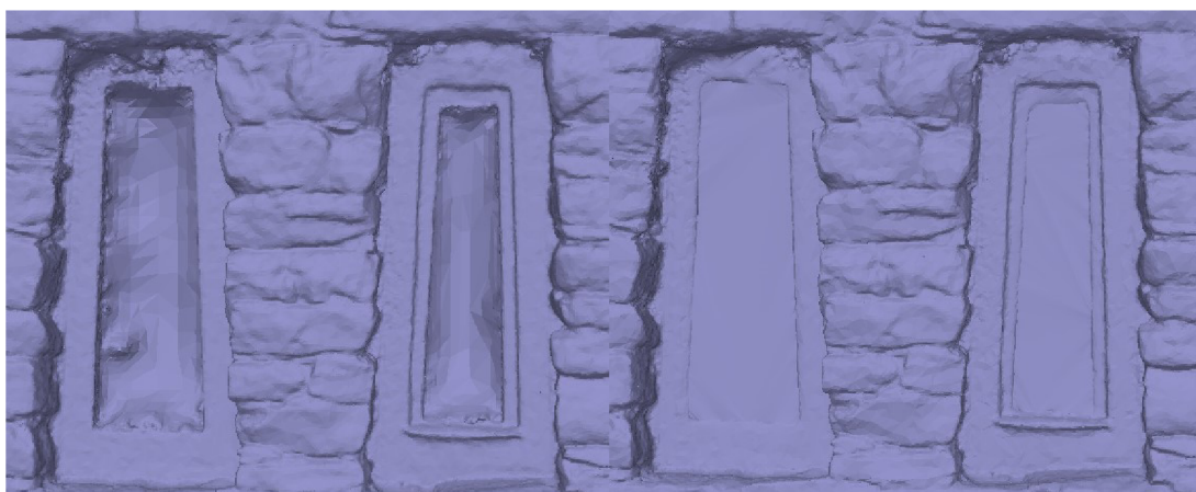
Obr. 18 Ukázka oken před úpravou (vlevo) a po jejich vyhlazení (vpravo).
