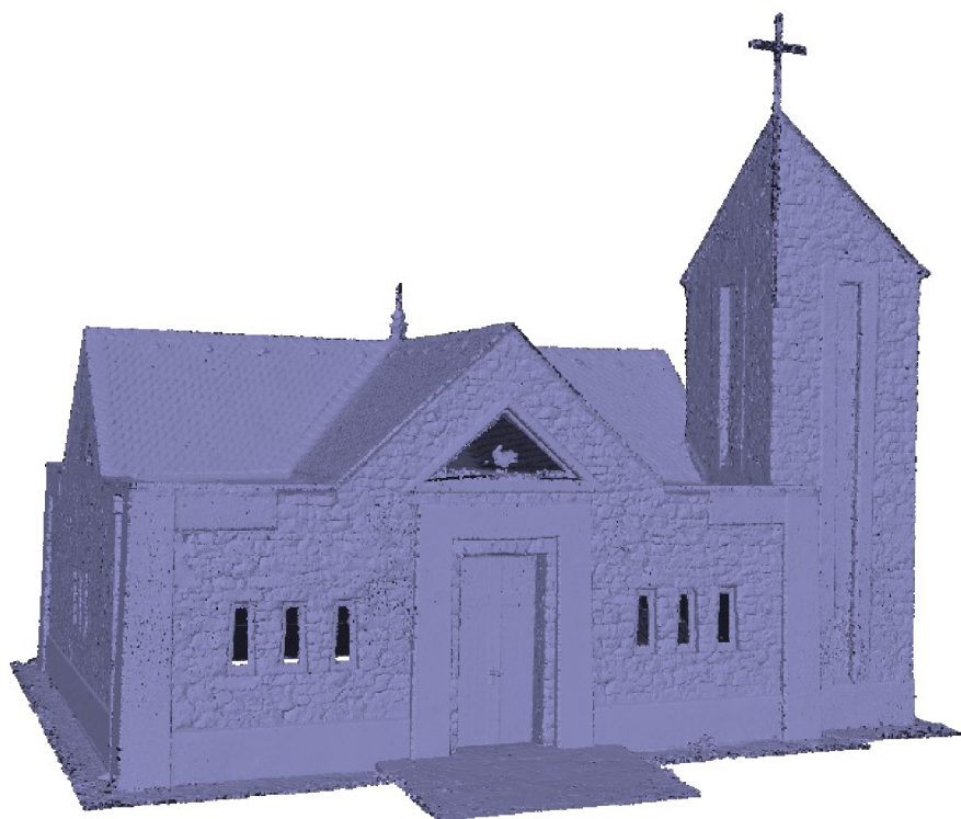
Obr. 15 Spojená mračna bodů Xiaomi + Phantom.
