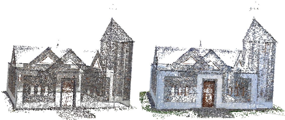
Obr. 9 Filtrované Tie Points projektů Canon (vlevo) a Xiaomi (vpravo).
