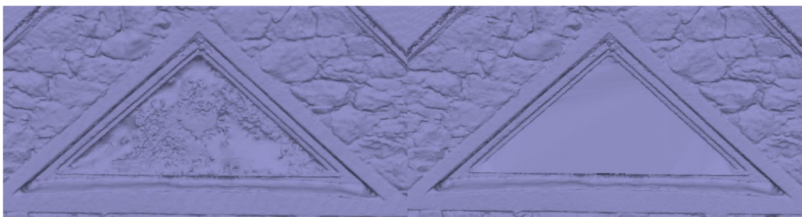
Obr. 21 Porovnání okna před úpravou (vlevo) a po vyhlazení (vpravo).
