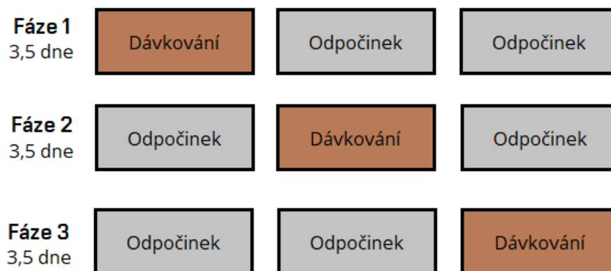
Obr. 12 - Distribuce odpadní vody na 1. stupeň
