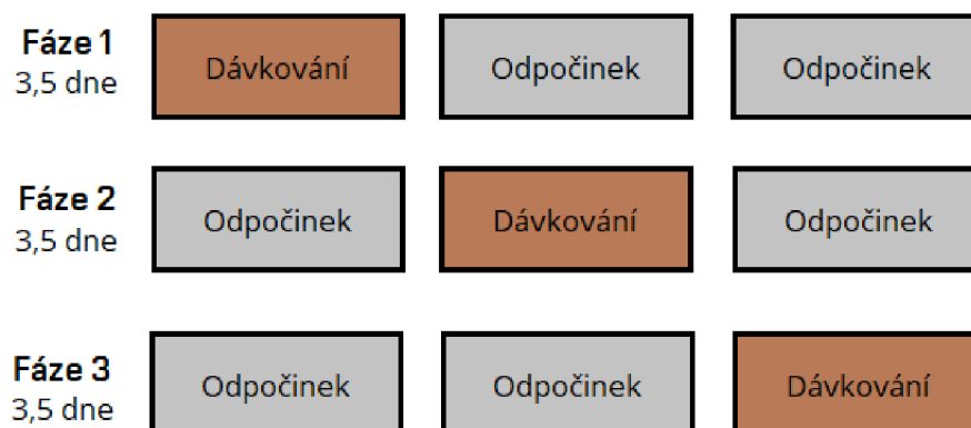
Obr. 12 - Distribuce odpadní vody na 1. stupeň
