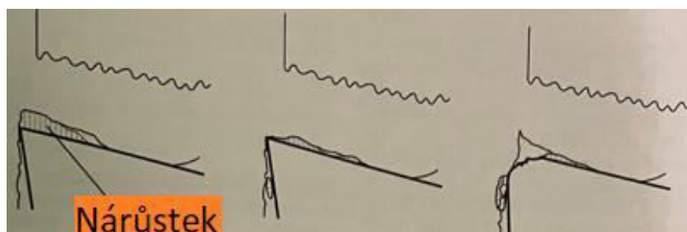
Obr. 12 Nárůstek na břitu nástroje [7]
