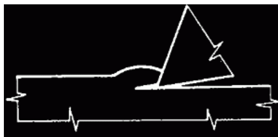
Obr. 8b Začátek porušování soudržnosti [13]
