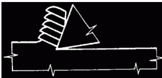
Obr. 8e Odvádění třísky po čele nástroje [13]
