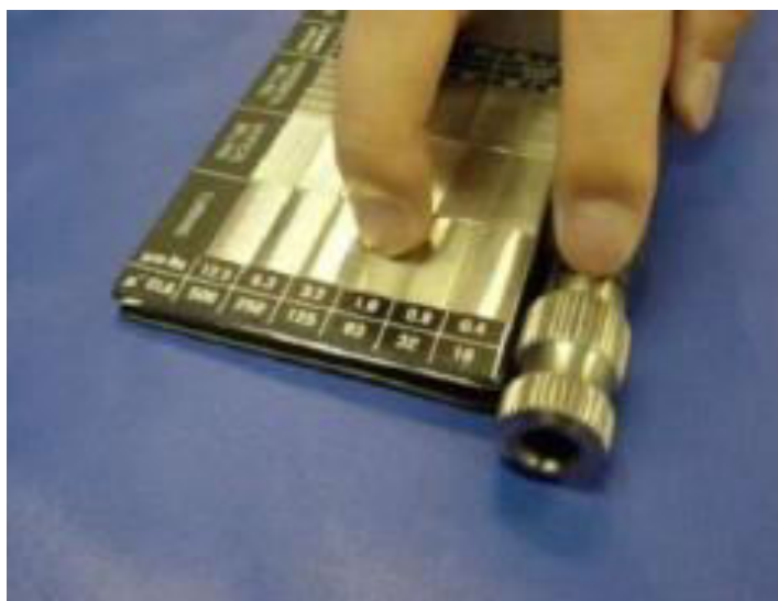
Obr. 19 Kvalitativní hodnocení pomocí vzorkovnice [23]
