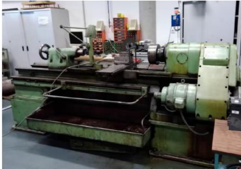
Obr. 22 Hrotový soustruh SU 50/1500
