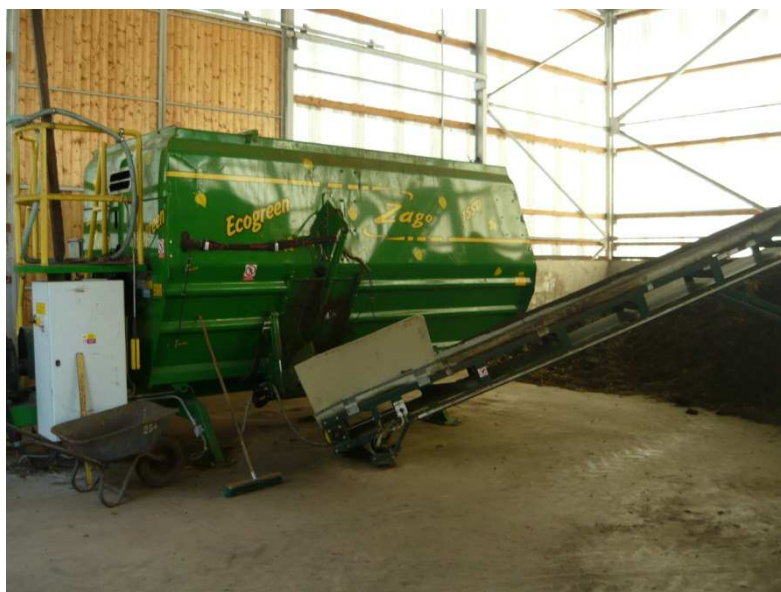
Obr. 21 Homogenizátor Ecogreen Zago používaný k drcení a míchání vstupních surovin (Šváb, 2014)
