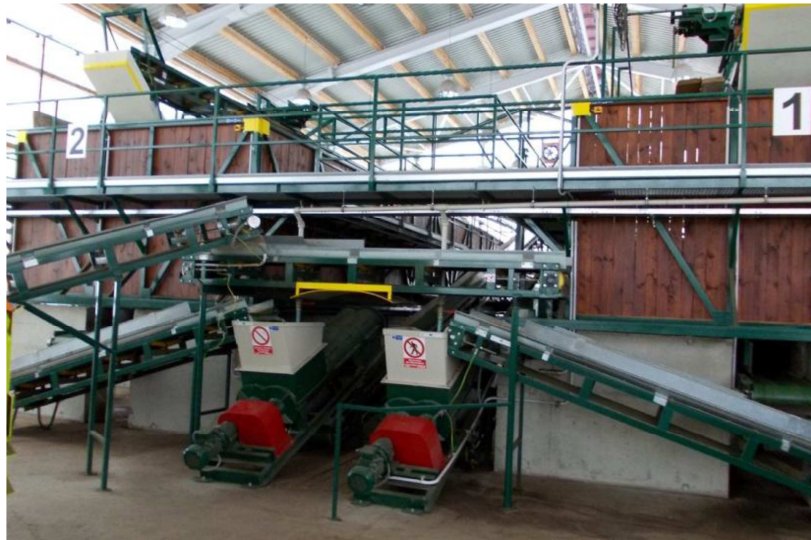
Obr. 23 Pásové dopravníky pro naskladnění a vyskladnění materiálu (Via alta a.s., 2012)
