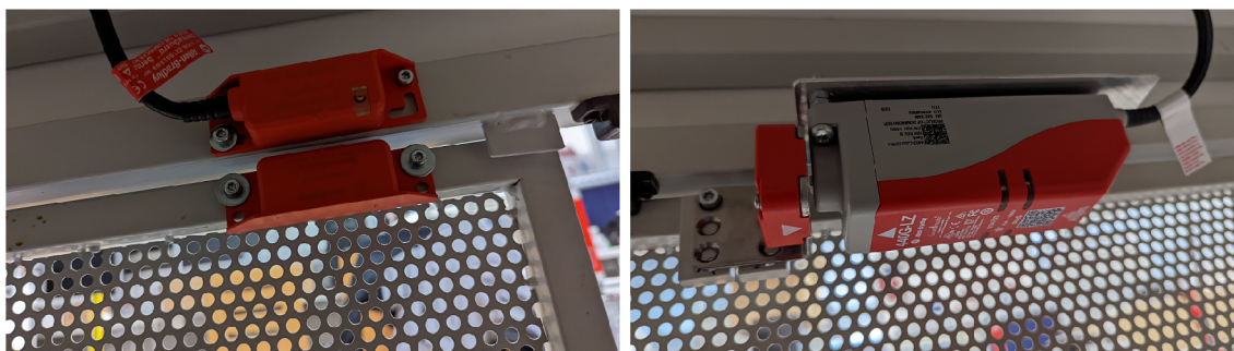
Obr. 7.9: Umístění bezpečnostního zámku a bezkontaktního snímače
