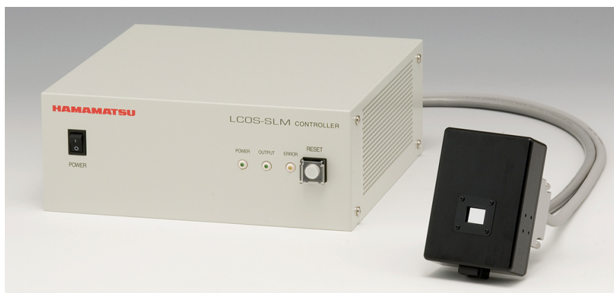
Obrázek 1.3: Fázový prostorový modulátor světla Hamamatsu X10468. Řídicí jednotka (vlevo) je propojena s částí obsahující aktivní displej (vpravo) [1].
