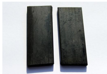
Obrázek 11 – Vzorky z kompozitního materiálu s uhlíkovým vláknem
