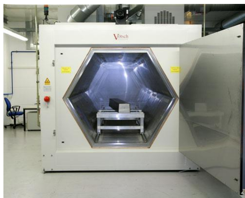
Obrázek 6 – Mikrovlnná pec Hephaistos firmy Vötsch [9]
