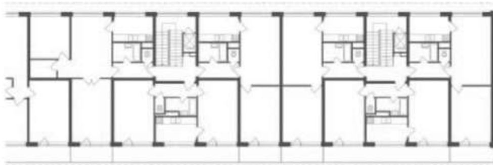
Obr. č. 54 – Realizované typické podlažie nástavby (13, s. 161)
