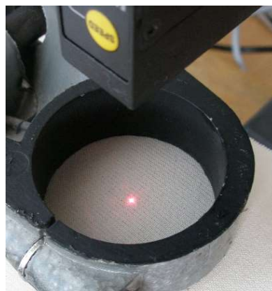
Obr. 45. Měření vydutí vzorku laserovým snímačem.
