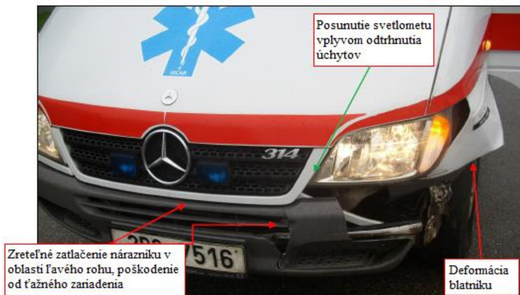
Obrázok 13 - Poškodenie ľavého predného rohu vozidla Mercedes , Zdroj: Súkromný posudok [42]
