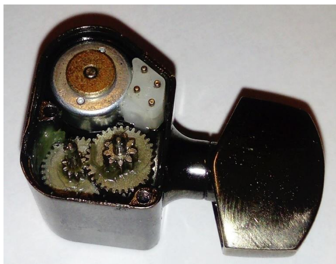
Obr. 8 Rozebraná ladicí mechanika RoboHead
