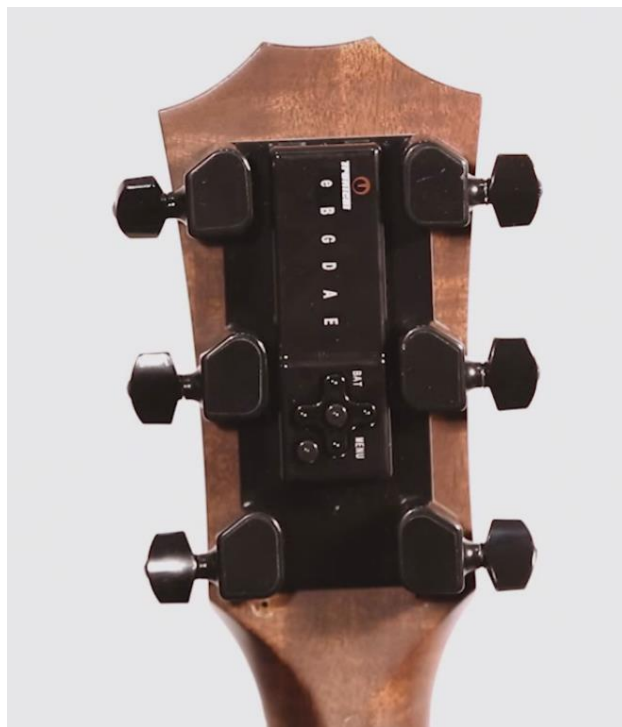
Obr. 5 Tronical Tune s ladicí mechanikou na obou stranách [3]
