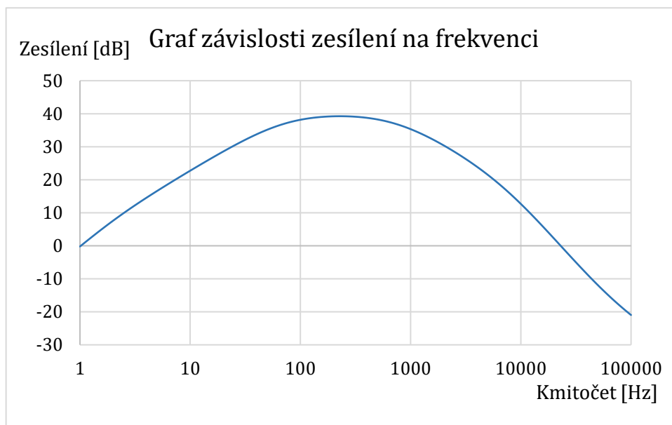
Obr. 23 Výstupní charakteristika zesilovače a kmitočtových filtrů
