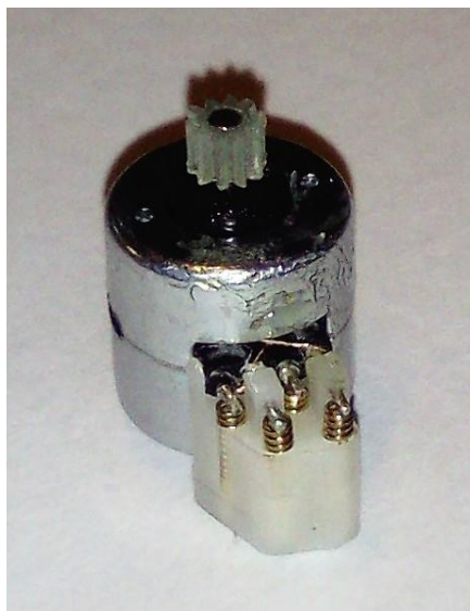
Obr. 9 Krokový motor z ladicí mechaniky RoboHead
