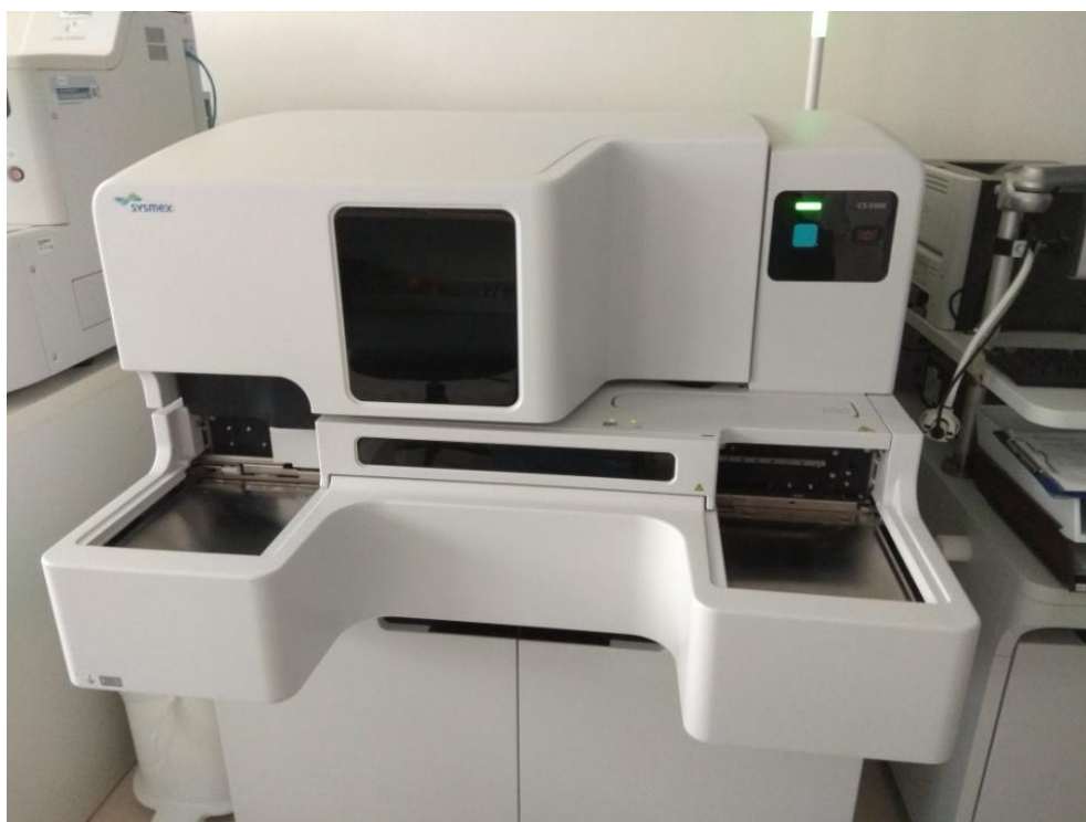
Obr. 5: Automatický koagulační analyzátor Sysmex CS-5100. Zdroj: vlastní foto
