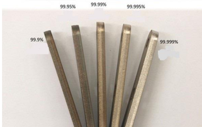
Obr. 21: Znečištění kyslíkem při tavné metodě [39]
