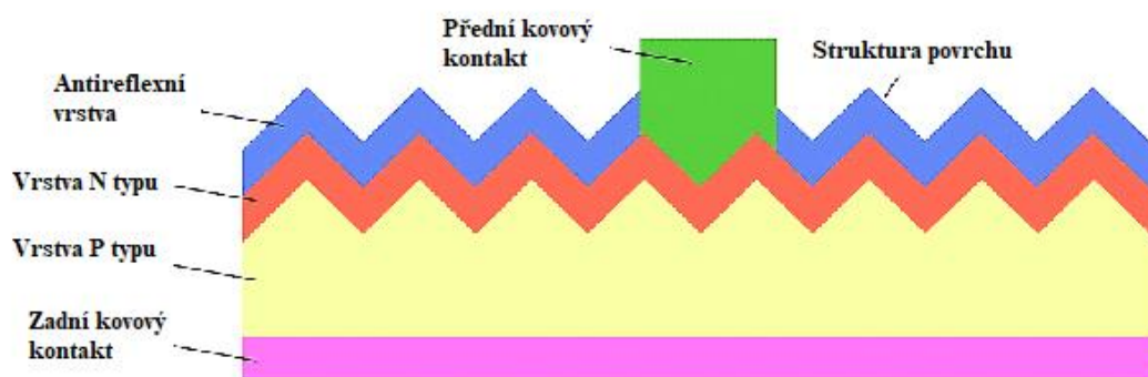
Obrázek 2.1 Porovnání monokrystalického a polykrystalického článku + struktura článků
