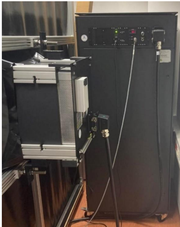
Obrázek 4.5 Zábleskový generátor a lampa za zadní části temné komory
