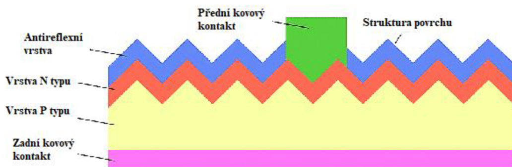
Obrázek 2.1 Porovnání monokrystalického a polykrystalického článku + struktura článků
