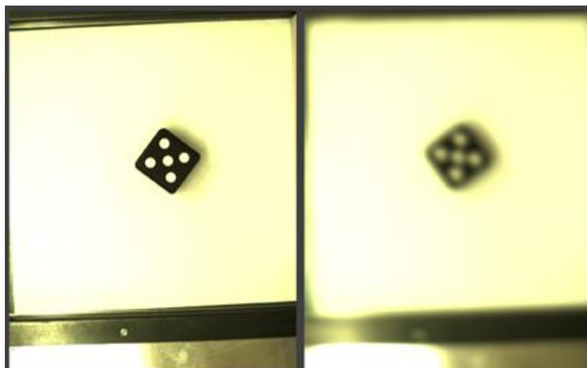
Obr. 3.3: Rozdíl v ostření z pohledu kamery
